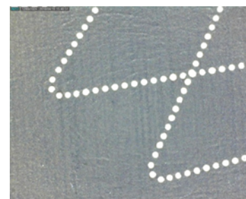
SDC 機能があるときの加工結果 (ガルバノが減速するコーナー部分でも パルス間隔を調整して加工できる)
